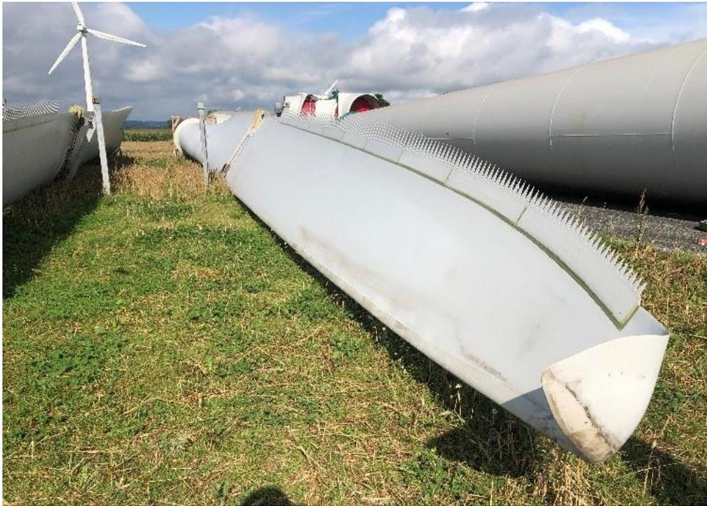
Figure28:Exemple d'une pale équipée de "serrations" - Parc éolien de Lanfains -Kallista Energy
